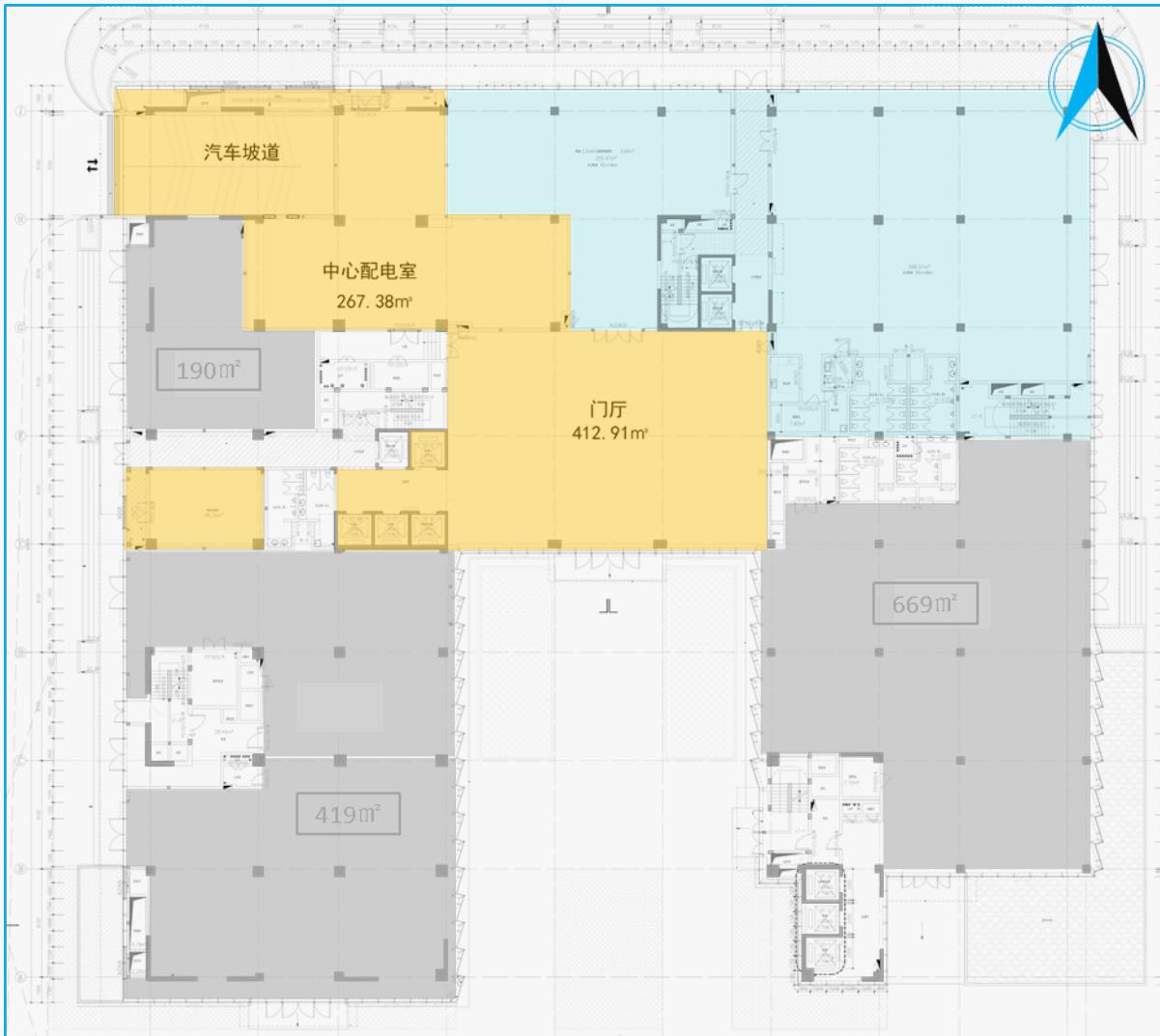
标准轴网：8.1\*8.1米，面积65.6m<sup>2</sup>；过道轴网：6.0\*8.1米，面积48.6m<sup>2</sup>
